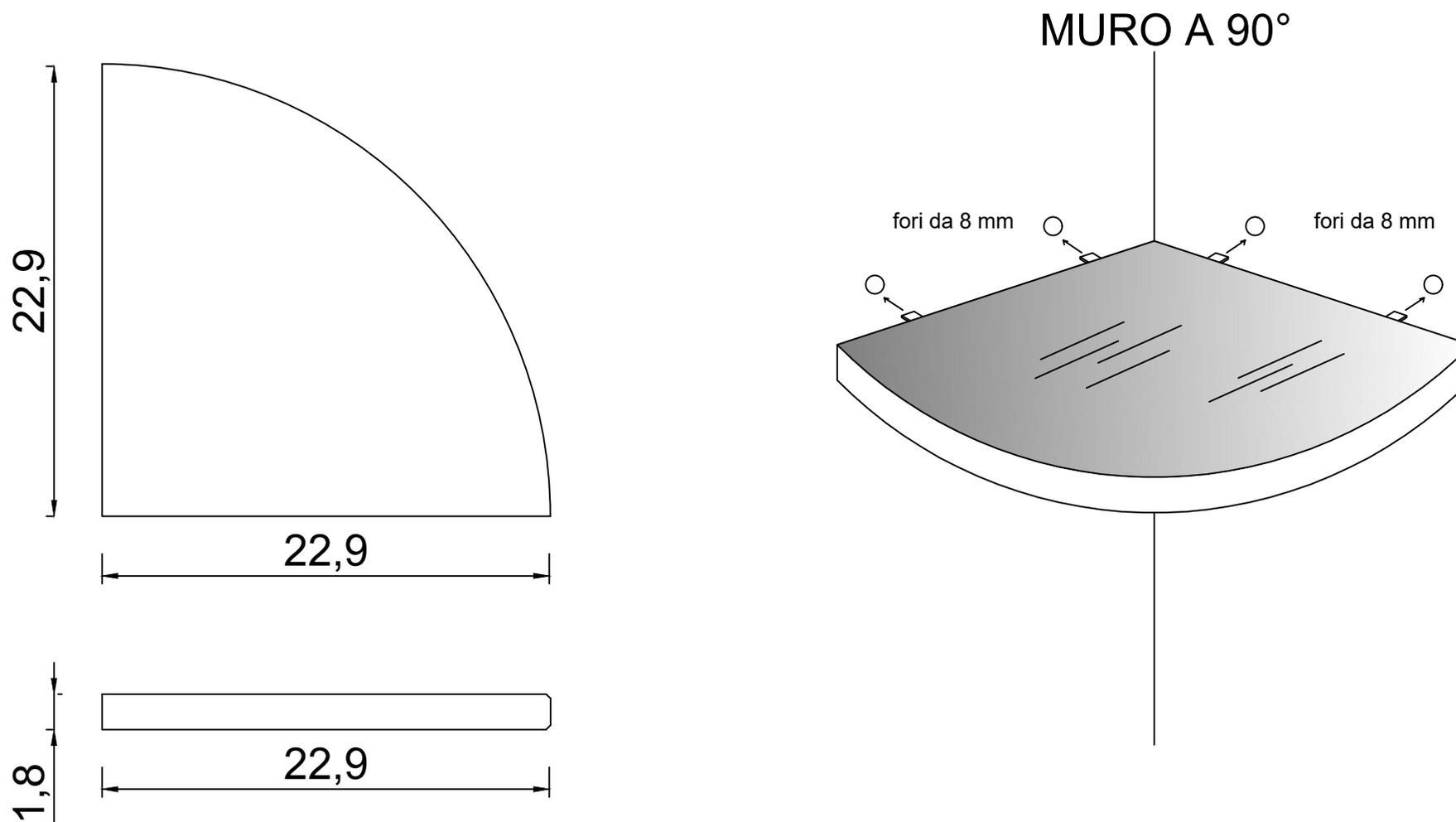
PER IL MONTAGGIO, UTILIZZARE TUTTO IL MATERIALE IN DOTAZIONE
