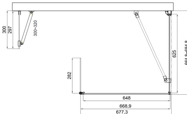
**NOTA BENE:** Quando viene utilizzato il Profilo Angolare per unire 2 Lati Fissi, il cristallo del Lato Fisso **INLINE** va siliconato al Profilo Angolare e per questo perde l'estensibilità, ma prende una dimensione d'ingombro fissa.
