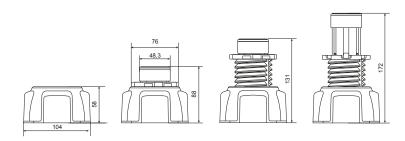
Matière : tampon en SBS\*, support-tampon, écrou rallonge, vis et embase en PP \*SBS : styrène-butadiène-styrène
