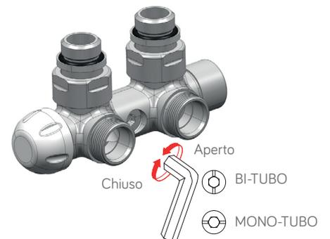
Per cambiare la configurazione della valvola da monotubo a bitubo, chiudere il by-pass con una chiave a brugola da 6 mm ruotando il taglio della vite in direzione verticale come mostrato nell'immagine. Aprire il by-pass per effettuare la configurazione monotubo.
